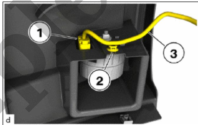
(f) Disengage the clamp (2).
