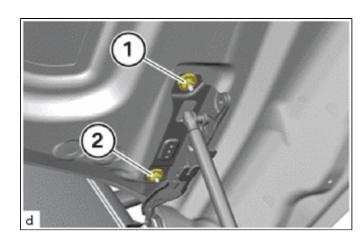
(d) Adjust hood lock striker (1) by turning nut (2).
