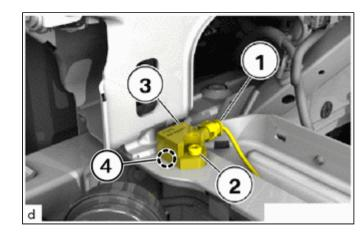
(d) Loosen the T30 bolt (2) and detach the guide (4) to remove the front airbag sensor (3).
