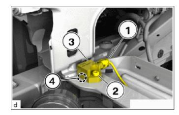
(d) Loosen the T30 bolt (2) and detach the guide (4) to remove the front airbag sensor (3).
