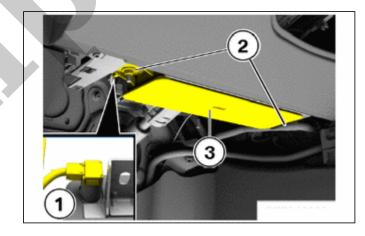
(d) Loosen the nuts (2) and remove the lower No. 2 instrument panel airbag assembly (3).
