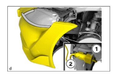
(e) Disengage the clamp (2).
