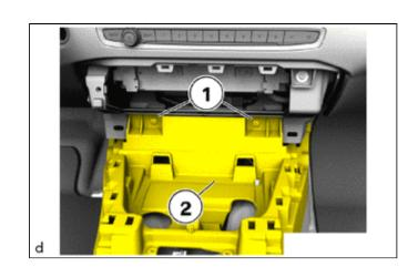
(d) Unlock plug connection (1) and disconnect.
