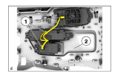
(d) Remove the upper console panel sub-assembly (2).
