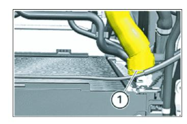
(d) Unlock plug connection (1) and disconnect.
